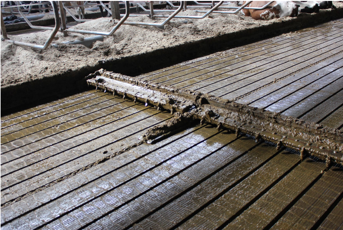
Figuur 24: Mestschuif uitgerust met vingers om langssleuven te reinigen
