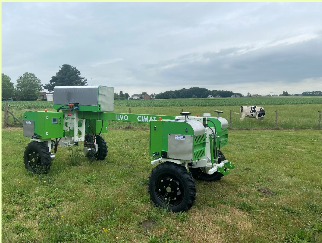
Figuur 7 In het kader van het CIMAT-project (Interreg) werken 11 Vlaamse en Nederlandse partners aan de ontwikkeling van een autonoom werktuigplatform met modulaire gereedschappen voor uiteenlopende taken. ILVO
