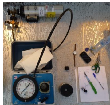
Figuur 2.2. Een schematische voorstelling van een drukkombom (links) (Taiz, 2010) en een afbeelding uit de praktijk (rechts).
