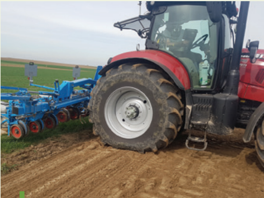
Figuur 4: Weeg de combinatie en kijk in de bandenspanningstabel welke bandendruk je mag gebruiken. Door de bandendruk te verlagen puilt de band uit in de breedte maar plat hij ook beduidend meer af in de lengte, zoals te zien is op de foto.
