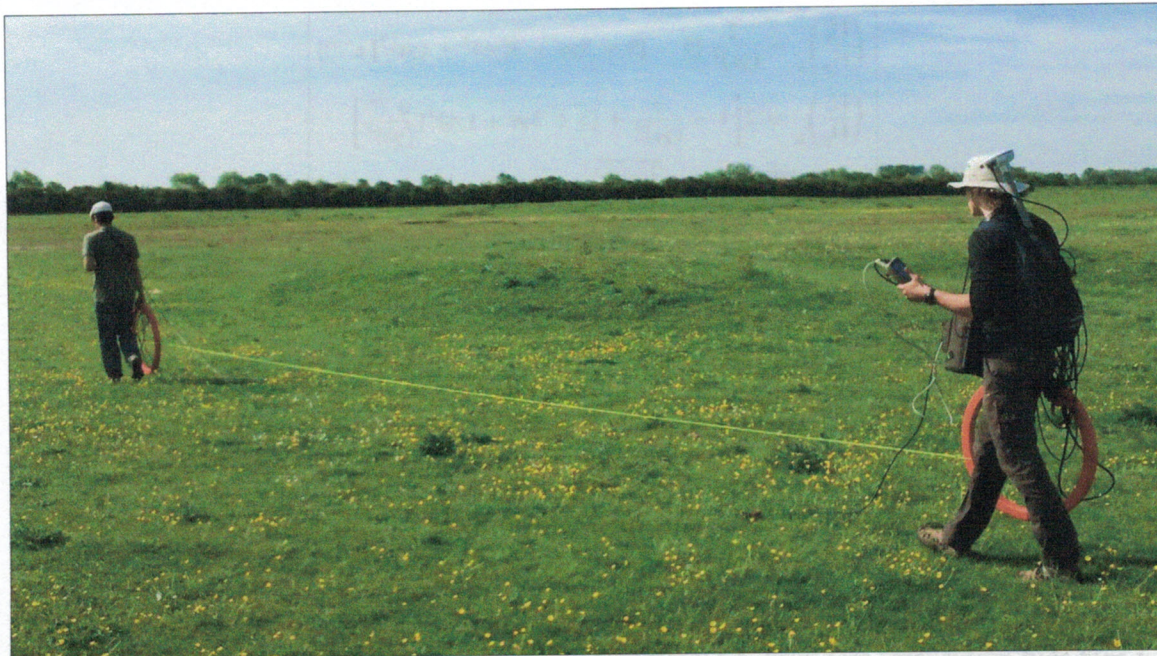
Figuur 2 Uitvoering van de EM34-metingen (20/05/2014).
