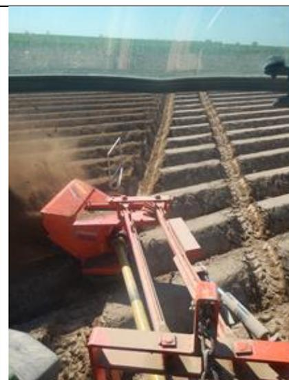
**Le rigolage bien fait** - c'est le cas sur ces 2 photos ! - fait travailler la rigoleuse dans la trace d'une des roues. Il s'agit aussi de faire une rigole de la bonne profondeur, ni trop profonde ni trop superficielle.
